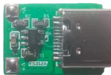
图 1. FS312A 接 TYPE-C 母座 DEMO
