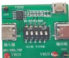
图 2. 带拨码开关和 MicroB 外部供电的 DEMO
